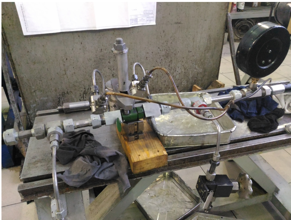
Рис. 9. Стенд для снятия статических характеристик ОК
