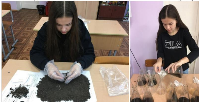
Рис. 3. Удаление посторонних включений и приготовление водного раствора
